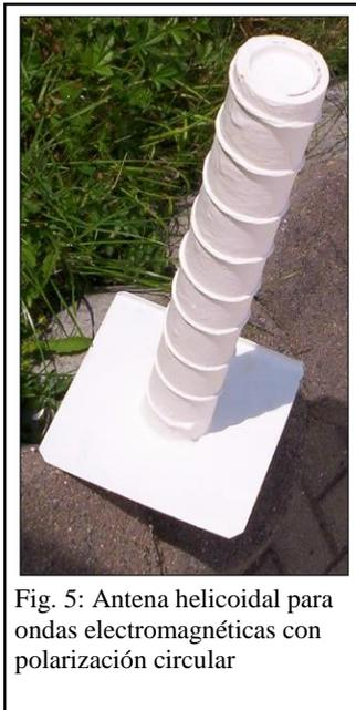
Fig. 5: Antena helicoidal para ondas electromagnéticas con polarización circular
