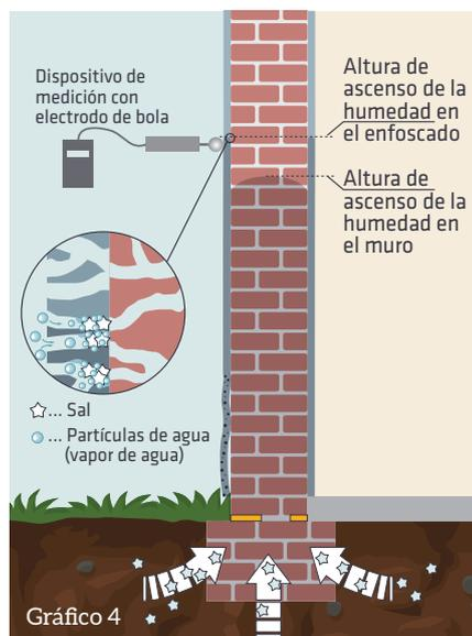
En el enfoscado se han depositado sales que atraen la humedad ambiental (humedad higroscópica). Esto se puede medir con el método de alta frecuencia, que no daña la superficie (gráfico 4).
